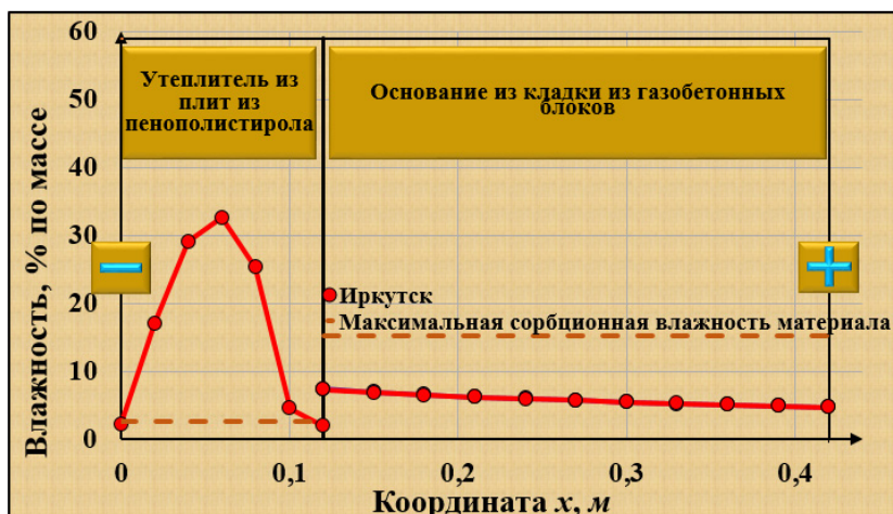
Рис. 1. Расчет влажностного режима СФТК для стены здания, построенной в сухой зоне строительства (г. Иркутск)
