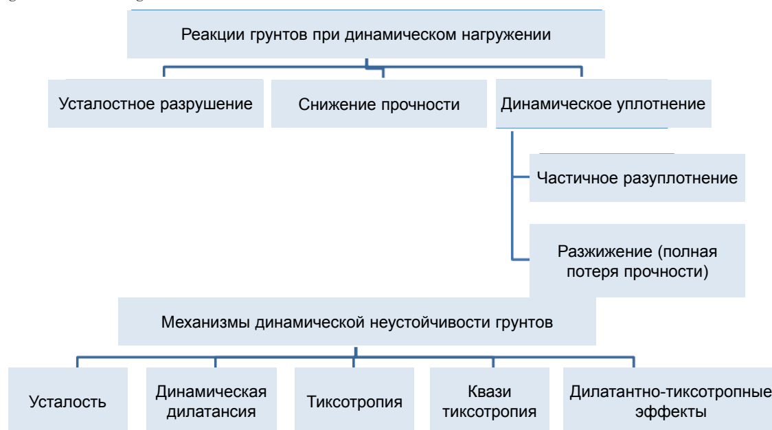
Рис. 1. Формы реакции грунтов при динамическом нагружении и механизмы динамической неустойчивости грунтов
