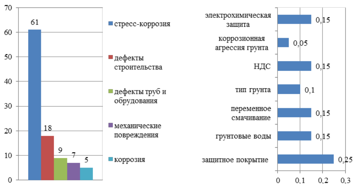
Рис. 1. Частота выявления причин, влияющих на повреждения конструкций НГП, % (а); вес факторов, влияющих на стресс-коррозию (б) (составлено по данным [2, 3])
