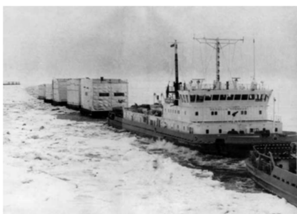
Рис. 3. Проводка суперблоков по Обской губе на Ямбургское нефтегазоконденсатное месторождение
