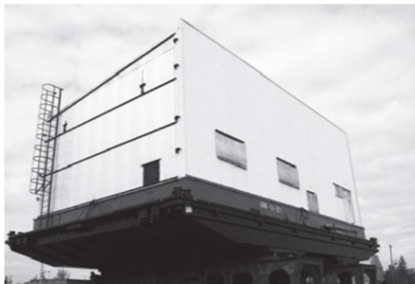
Рис. 1. Блок-понтон противопожарный насосной перед спуском на воду
