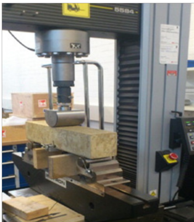
Рис. 2. Испытание образца с АКДВ на изгиб
